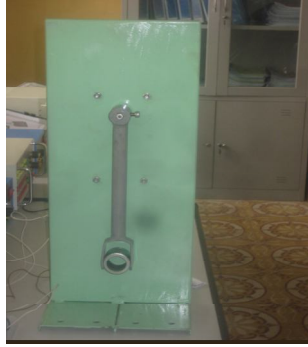
Hình 2. Mặt trước của mô hình vật lý với cánh tay máy một bậc tự do.
