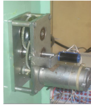
Hình 3. Mặt sau của mô hình vật lý với động cơ truyền động và cảm biến góc quay.
