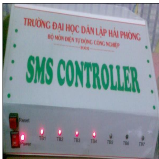
Hình 11. Mô hình bộ điều khiển thiết bị điện trong nhà. Các đèn báo các thiết bị trong nhà đã hoạt động.
