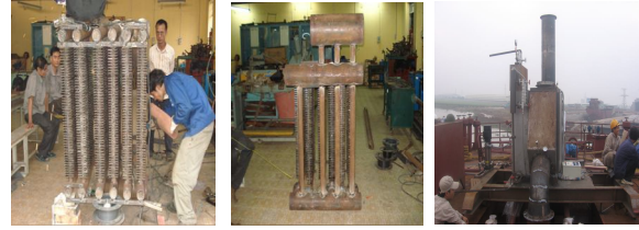
Hình 10. Một số hình ảnh chế tạo nồi hơi khí xả và bộ hâm nước tiết kiệm kiểu moduyn.
