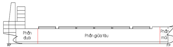
Hình 1: Thân tàu được thiết kế từ 3 phần giữa, mũi và đuôi tàu
