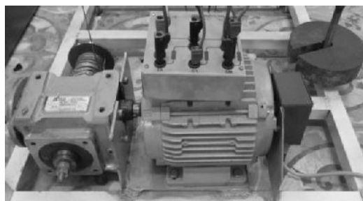
Hình 7. Hình ảnh mô hình vật lý hệ thống tự động điều chỉnh sức căng tời quần dây
