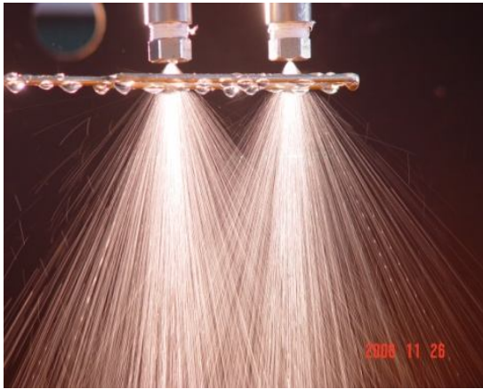
Hình 4. Phun nước bão hòa
