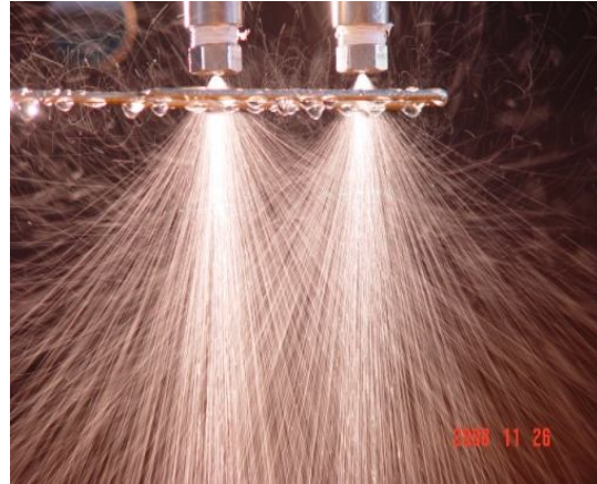
Hình 5. Phun nước được nạp điện
