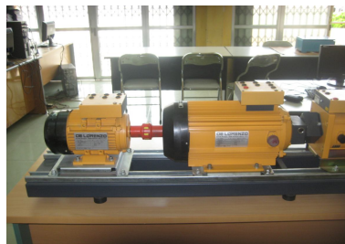
Hình 1. Máy phát điện cùng động cơ lai.
