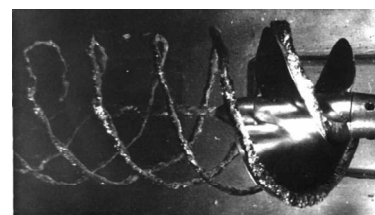
Hình 7: Hình ảnh xâm thực chân vịt tàu thủy [www.ksri.ru]
