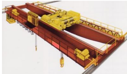
Hình 1. Cơ cấu nâng của cầu trục.
