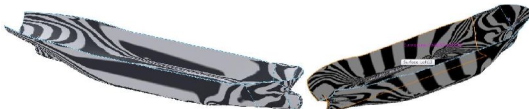
Hình 3.6. Kiểm tra độ trơn của bề mặt vỏ tàu thủy bằng phổ màu
