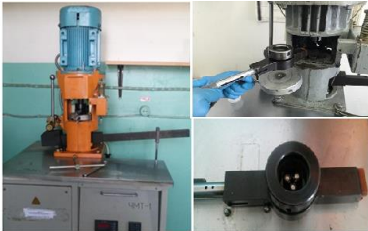
Hình 1. Thiết bị đo độ bôi trơn ЧМТ
