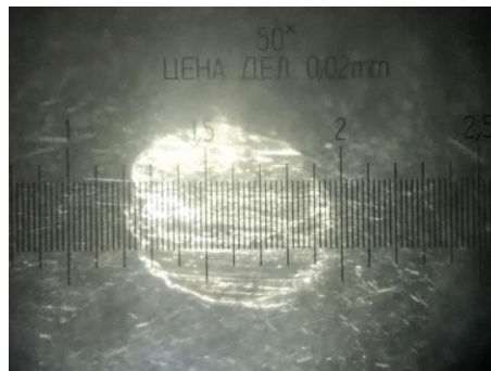
Hình 2. Xác định đường kính mài mòn bi cầu
