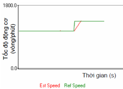
Hình 10. Đáp ứng tốc độ khi thực nghiệm khi tốc độ đặt từ 1000 lên 1500 vòng/phút
