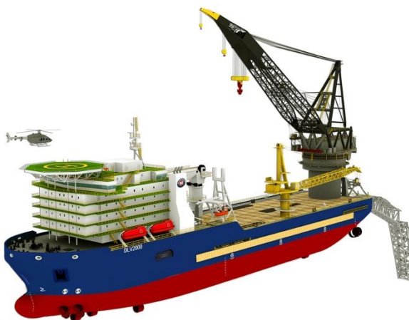
Hình 1-12. Tàu rải ống (Pipe Laying Vessel)
