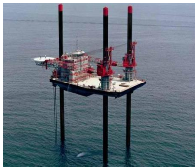
Hình 1.4. Kết cấu chân đế kiểu hình trụ.
