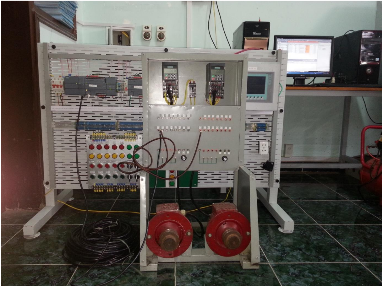
Hình 2.14. Mô hình truyền thông PLC - biến tần
