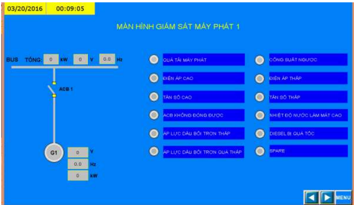
Hình 2.2 Giao diện màn hình giám sát máy phát số 1
