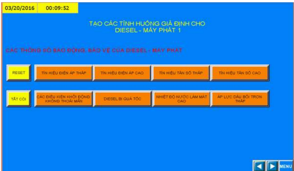
Hình 2.3 Giao diện màn hình tạo các tình huống giả định của Diesel - Máy phát
