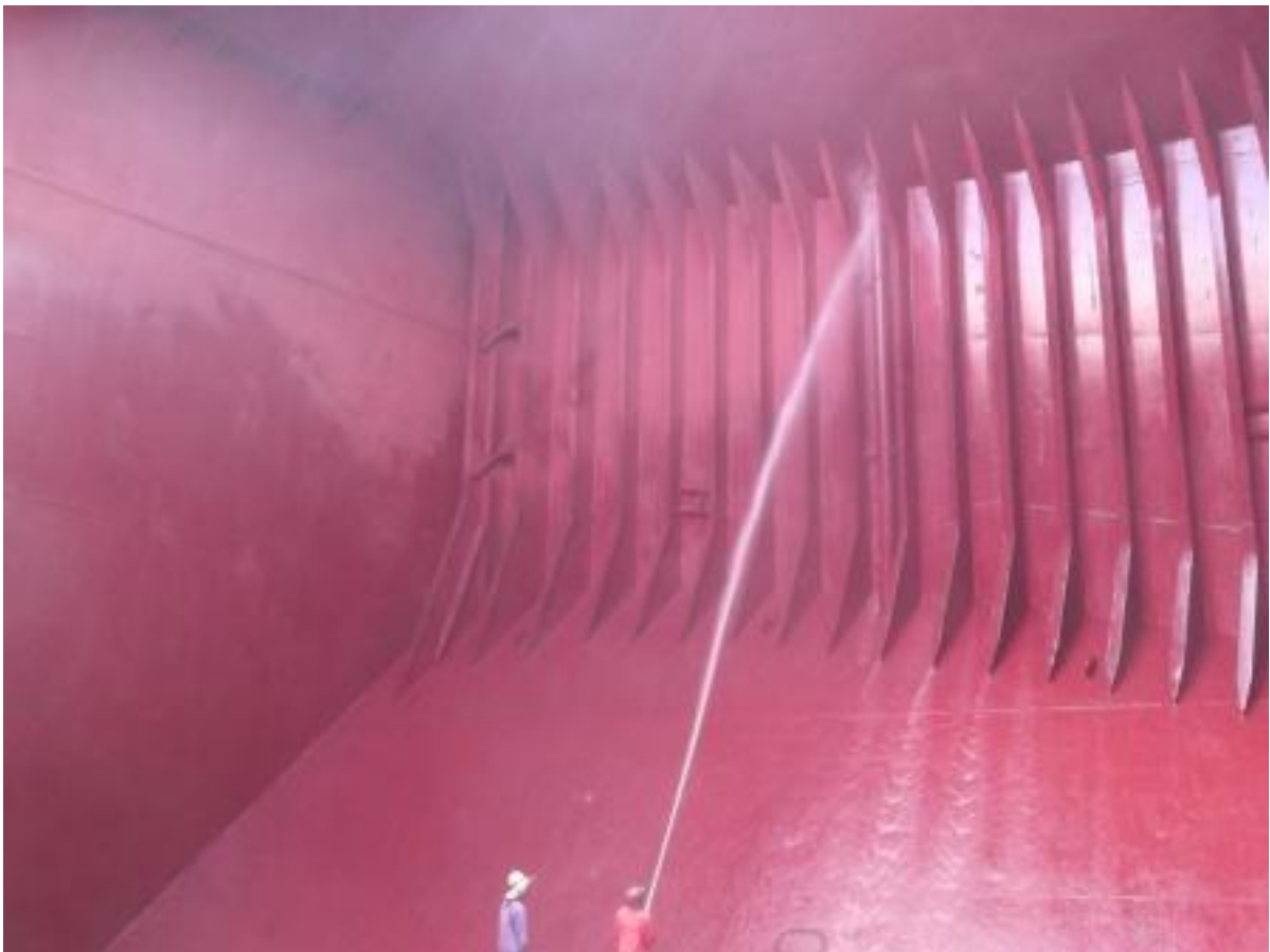
Hình 2.3: Rửa tráng hóa chất rửa hầm hàng
