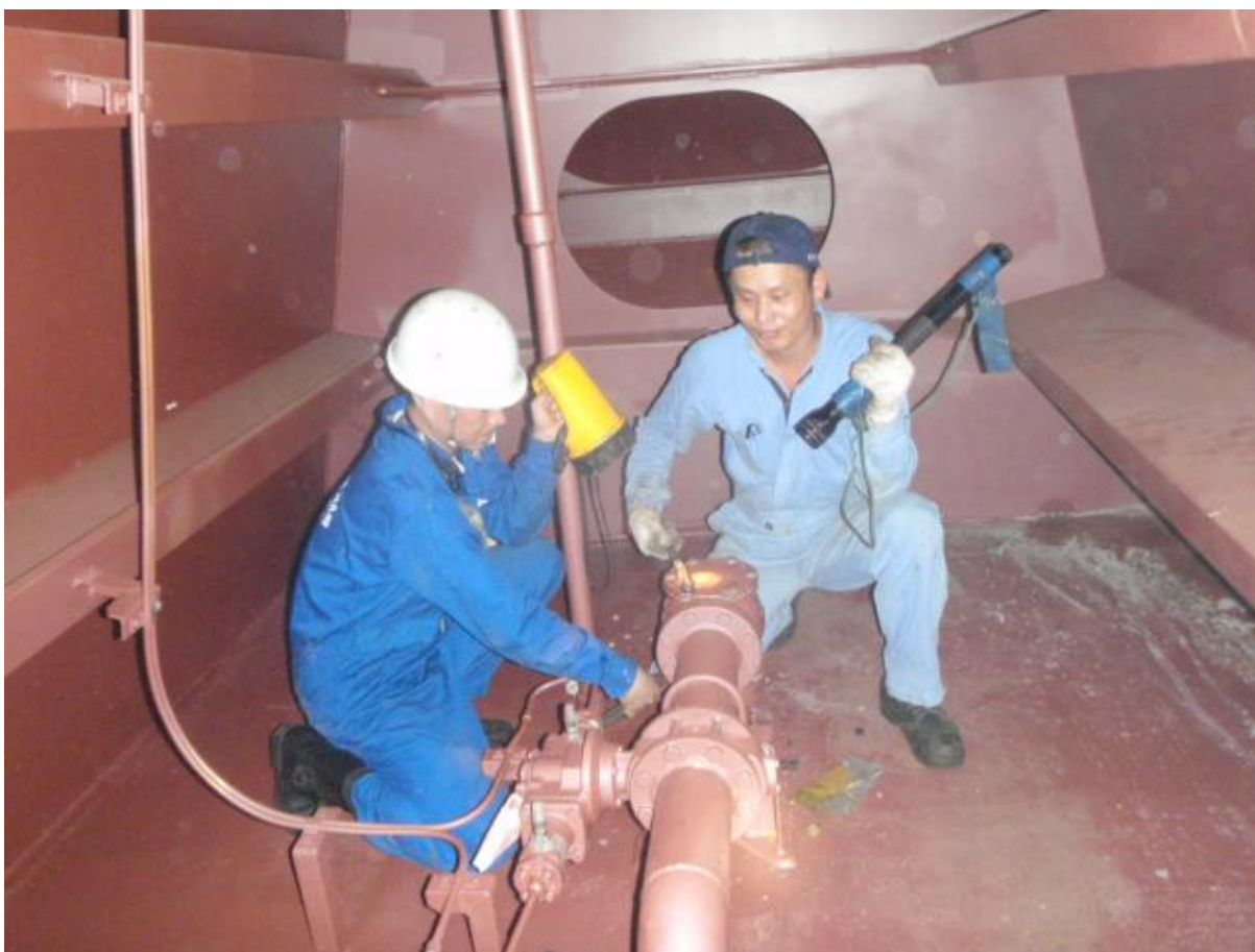
Hình 3.14: Bảo dưỡng van chặn và van một chiều trước hồ la canh
