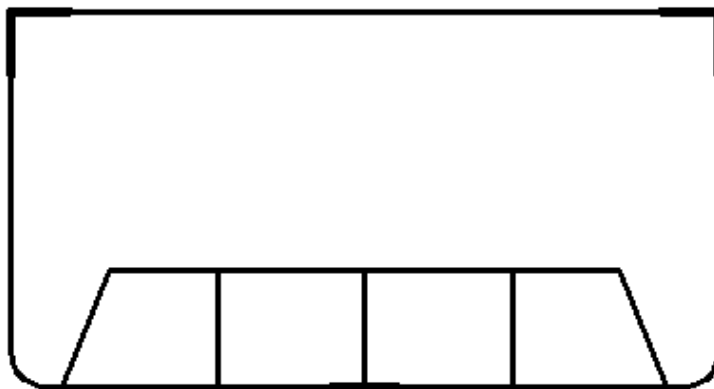
Hình 1.3. Mô hình sơ đồ kết cấu sườn giữa được dùng trong việc xây dựng công thức tính khối lượng các liên kết dọc
