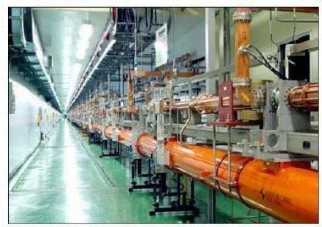
Hình 4. Máy gia tốc tuyến tính 2.5 GeV của Trung tâm Gia tốc Pohang
