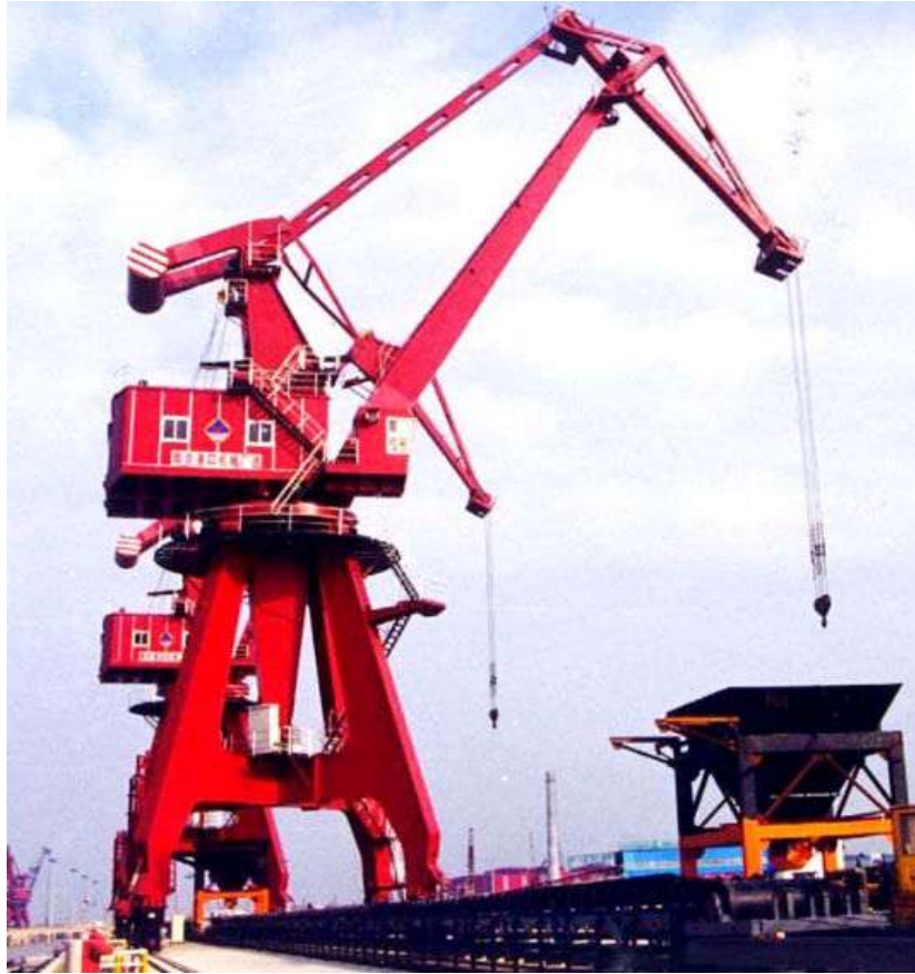
Hình 1.6 Thay đổi tầm với truyền động bằng thanh răng
