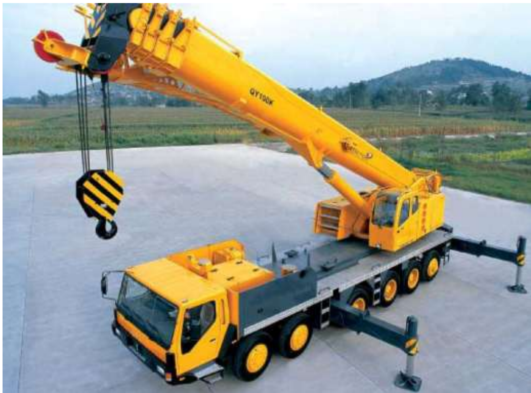
Hình 1.7 Thay đổi tầm với truyền động bằng xi lanh thủy lực.
