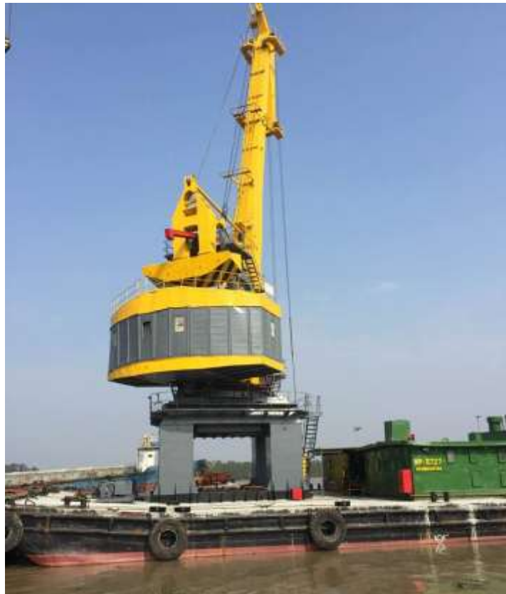
Hình 1.16 Cần trục có hệ cần kiểu khâu khớp sử dụng giằng mềm
