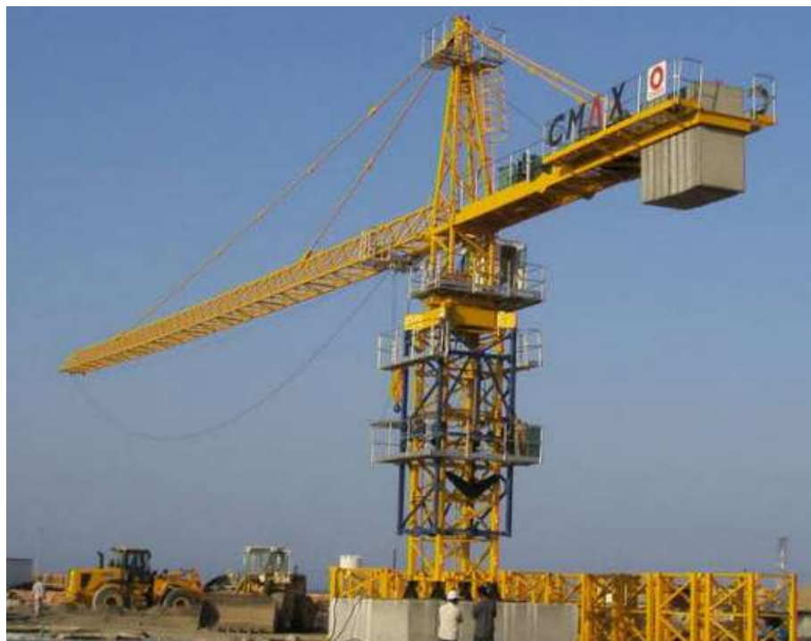
Hình 1.3 Xe con truyền động bằng cáp kéo
