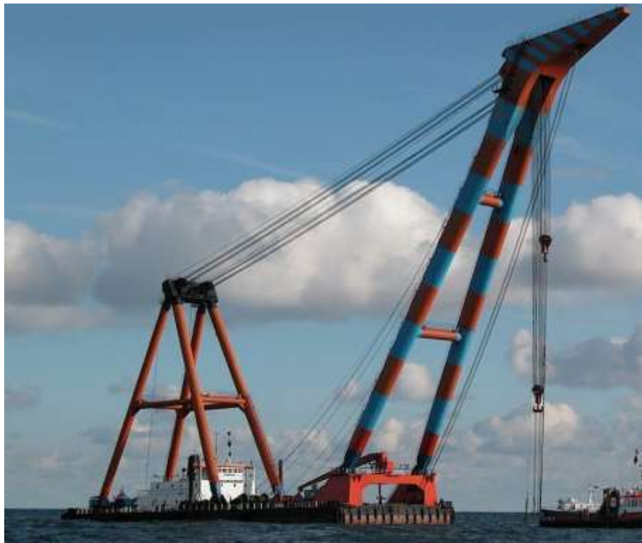
Hình 1.5. Thay đổi tầm với truyền động bằng cáp kéo
