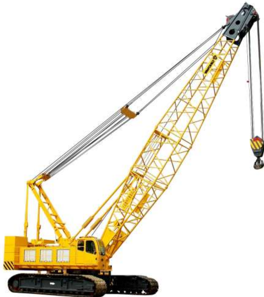
Hình 1.1 Thay đổi tầm với bằng cách lắc càn
