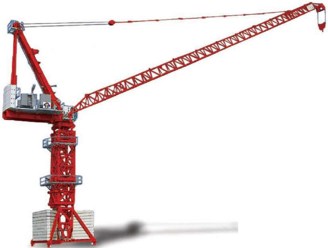
Hình 1.8. Kết cấu thép dàn
