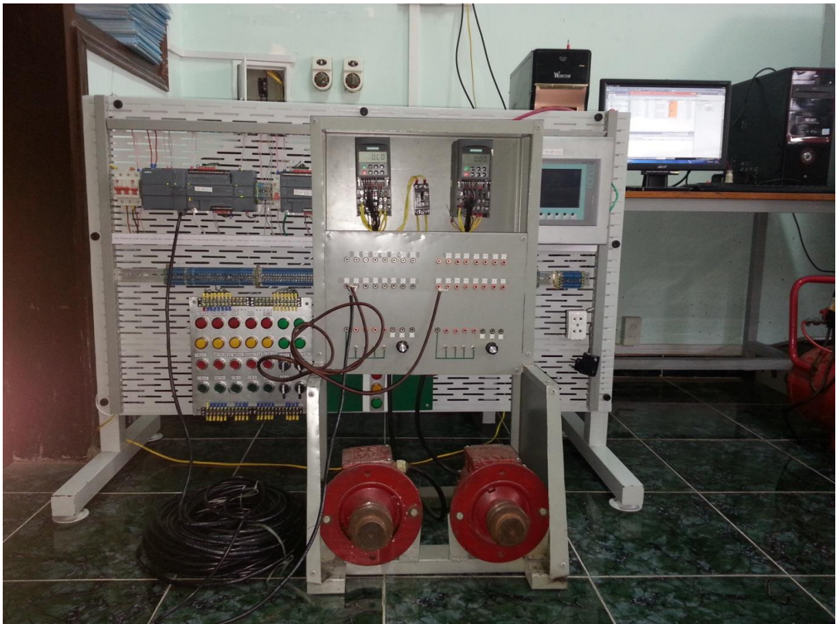
Hình 2.13. Mô hình truyền thông PLC - biến tần
