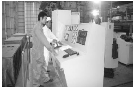
Hình 2.6. Thử hệ thống điều khiển tại xưởng
