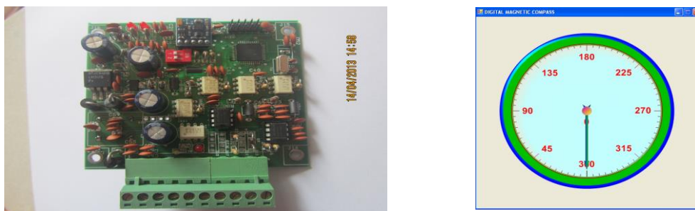
Hình 6. Hình ảnh tổng thể la bàn từ số và kết quả dữ liệu thu được trên phần mềm Visual C#
