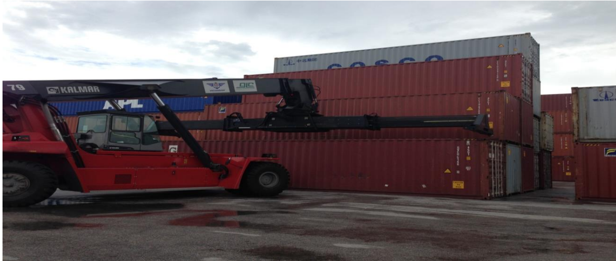
Hình 13 Xe nâng đang hoạt động trong bãi container của GLC
