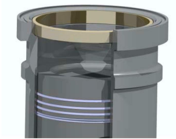
Hình 2.7. Kết cấu xy lanh động cơ và các rãnh xéc măng trên piston
