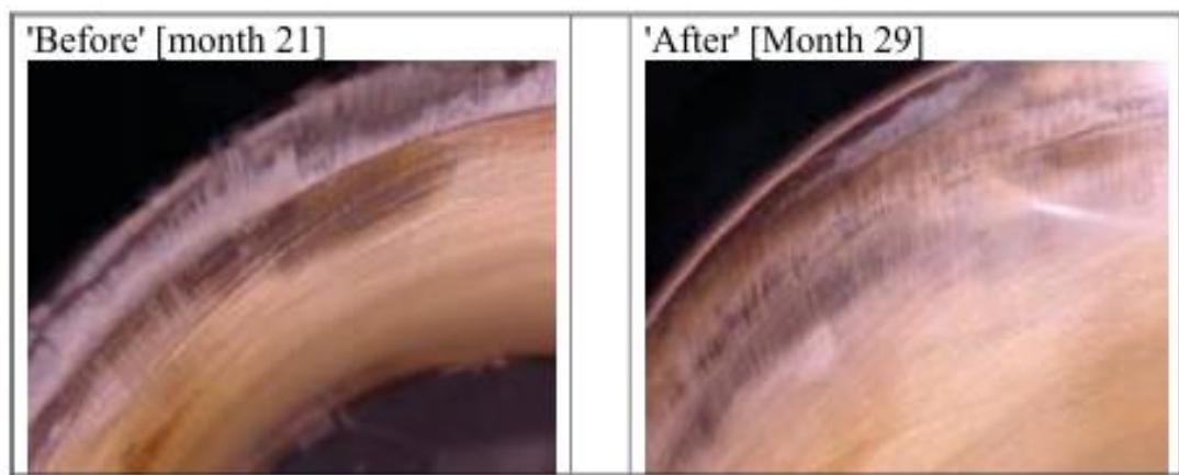
Hình 4.19. Ống lót xy lanh B5 trước và sau 8 tháng khảo sát với chất phụ gia. Cặn lacquer thay thế lớp bồ hóng ở phía trên xéc măng đối đầu.
