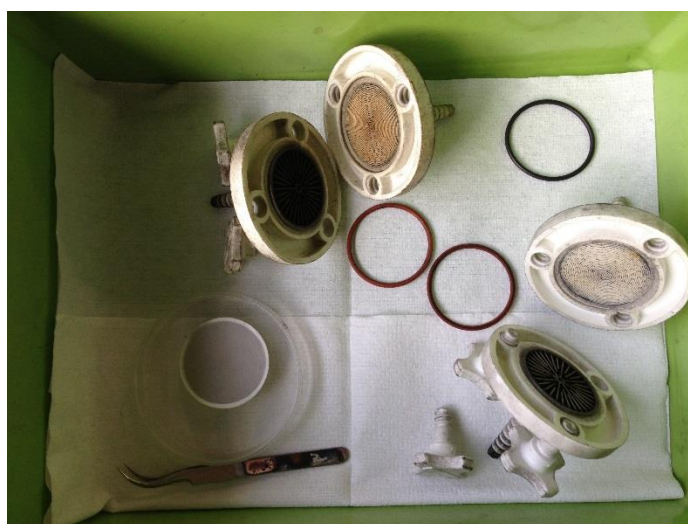
Hình 6. Phin lọc và thiết bị lấy mẫu trong khí xả động cơ
