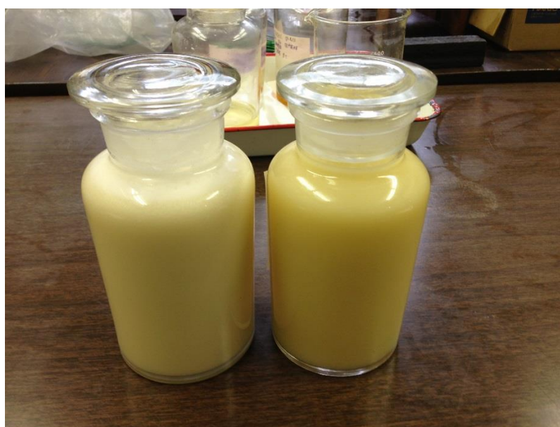
Hình 10. Nhiên liệu nhũ tương được tạo ra từ hệ thống hòa trộn
